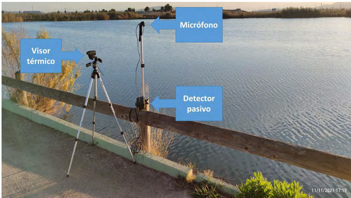
Figura 1. Montaje del dispositivo para el registro de la actividad de Myotis capaccinii y otros murciélagos. Se puede observar a la izquierda el visor térmico instalado sobre un trípode y a la derecha un detector SM4BAT FS conectado a su micrófono, montado en este caso sobre un monopie. Lagunas de Campotéjar (Región de Murcia; 11-11-2021).
